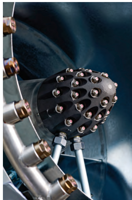
Dettaglio anello esterno e cluster centrale ugelli tipo TMP.
